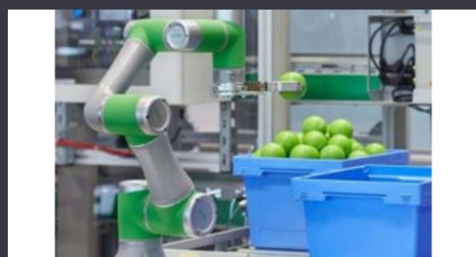
Cobot de Schneider puede levantar 3 kg y posicionarse a 20 µm
